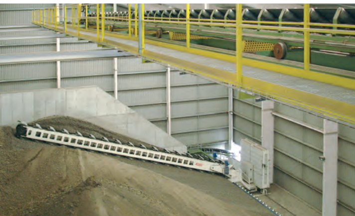
Linear reclaimers for longitudinal storage systems and Chevron filling pattern. / Excavateurs à godets sur rails pour entrepôt longitudinal et méthode de remplissage Chevron.
