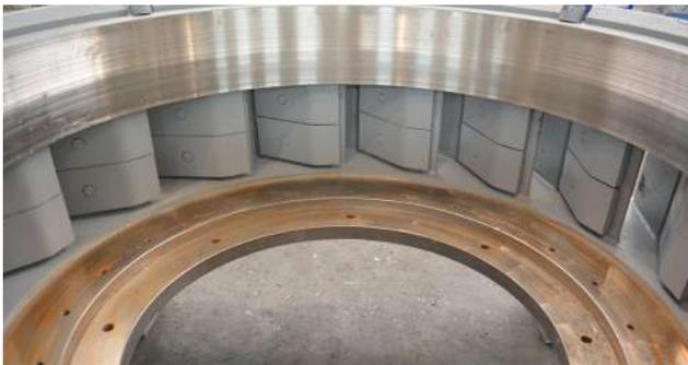
*La géométrie de l'enveloppe et du diffuseur assurent une répartition homogène du flux d'air dans la zone de laminage, garantissant ainsi les mêmes conditions de séparation et de sélection sur toute la bague de broyage.*
