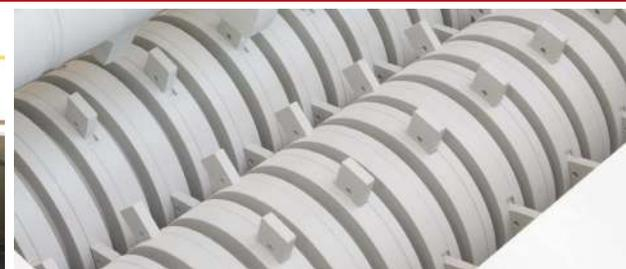
Los desmenuzadores son equipos adecuados para la trituración primaria del material procedente de cantera reduciendo su tamaño irregular original a dimensiones uniformes por debajo de 80 mm., facilitando así una correcta dosificación y almacenaje posterior. Especialmente diseñados para admitir materiales no ferrosos conteniendo porcentajes de humedad por encima del 20% y con una dureza máxima de 5 Mohs.
