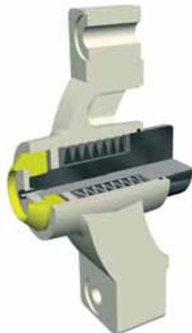
El sistema de amortiguación, protege la máquina de sobrecargas y de la entrada de cuerpos extraños, garantizando la presión de trabajo durante el funcionamiento del equipo. El sistema trabaja mediante la acción de resortes de discos elásticos. Los carenados laterales de fácil apertura otorgan una excelente accesibilidad para la sustitución de piezas.
